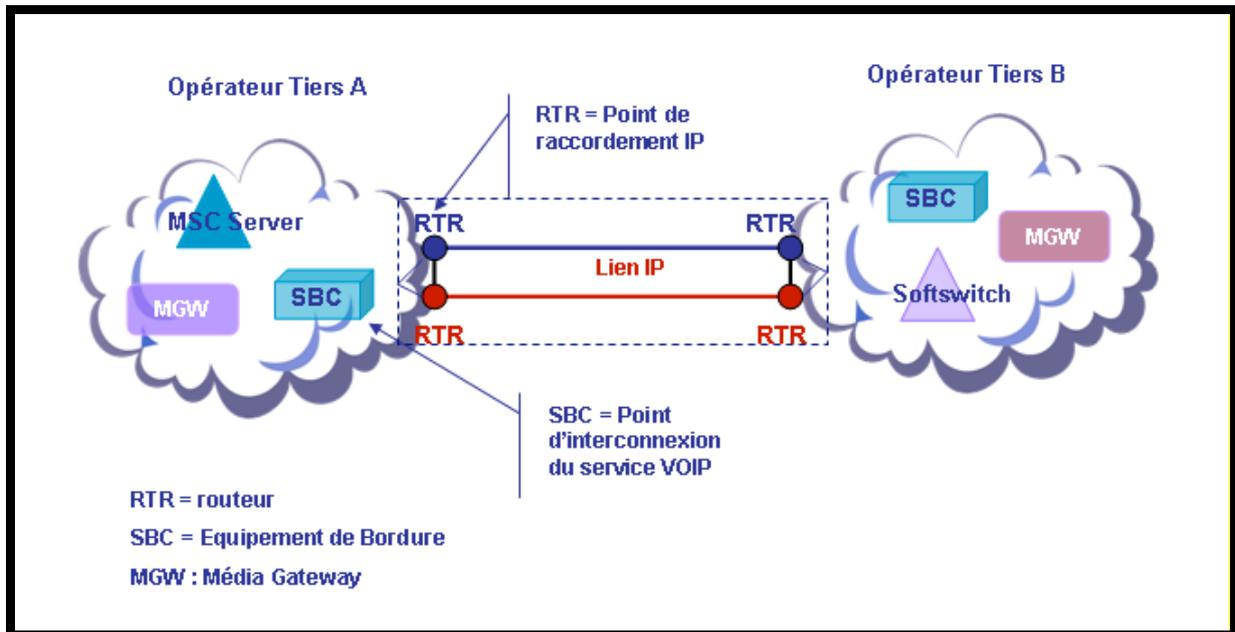
Figure 1 : Architecture de raccordement recommandée par la FFT [2]
